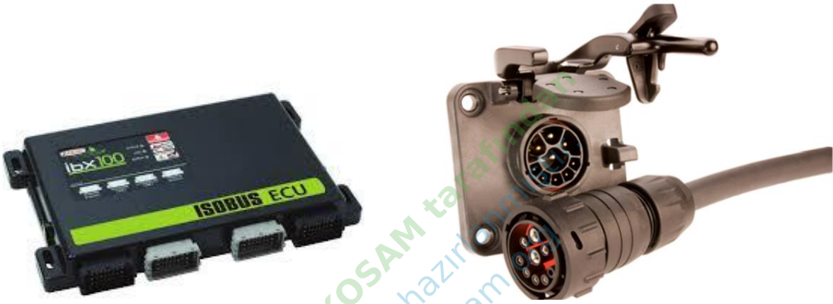
Şekil 15: ARAG Firmasına Ait Bir ISOBUS İş Bilgisayarı (ISOBUS-Elektronik Kontrol Ünitesi -ECU) ve Bağlantı Konnektörleri
